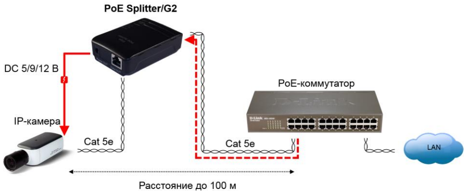
Рис. 4. Схема подключения сплиттера PoE Splitter/G2
