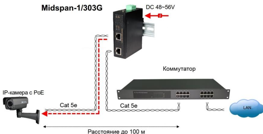
Рис.4 Типовая схема подключения инжектора Midspan-1/303G
