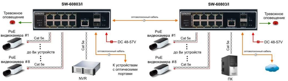
Рис.5 Схема каскадного подключения коммутатора SW-60803/I
