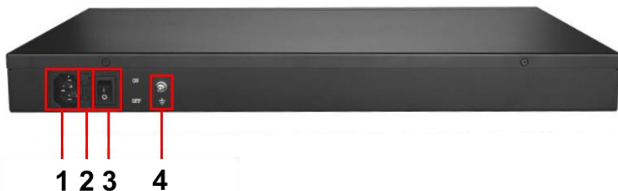
Рис. 3 Коммутатор SW-24G4X-1L, разъемы и кнопки на задней панели
