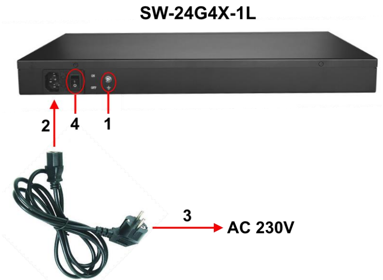
Рис. 6 Подключение коммутатора к сети AC 230V
