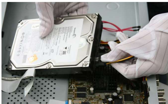
Рисунок 2-3 Подключение кабеля питания
