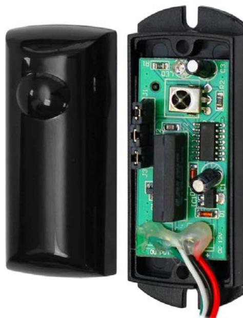
Активный уличный инфракрасный датчик ST-PD021BD-MC предназначен для обнаружения пересечения невидимого ИК барьера, создаваемого между передатчиком и приемником. Устройство может использоваться для защиты внешних и внутренних рубежей и отлично подходит для охраны объектов, периметр которых имеет значительную протяженность.
