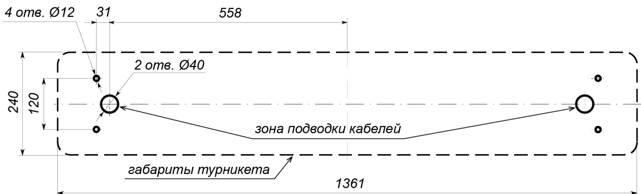
Рисунок 16. Схема разметки для установки стойки турникета
