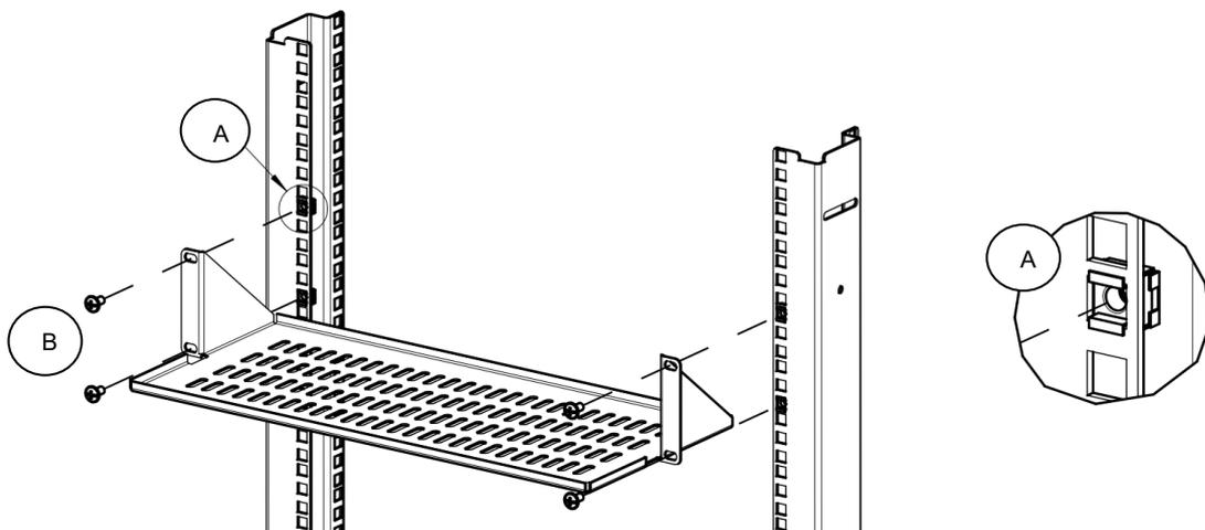
Рисунок 1. Установка консольной 2U полки с центральным креплением
